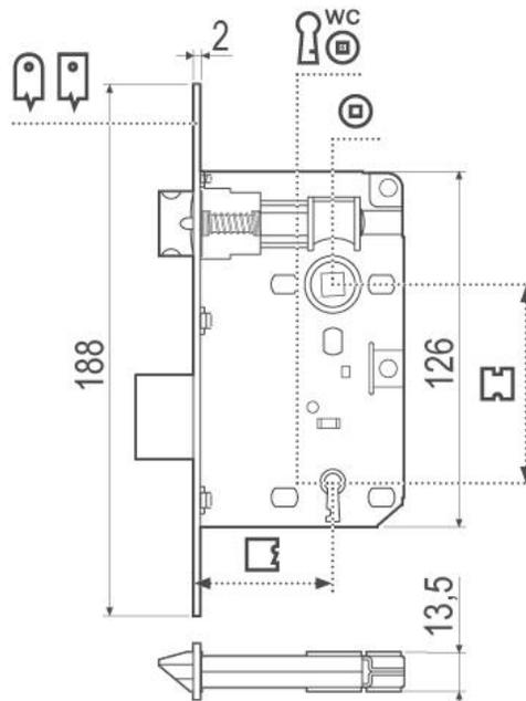
La versione ridotta della classica serratura da infilare per porte interne. Lo scrocco bombato su entrambi i lati per evitare scuotimenti della porta è reversibile per porte destre e sinistre.
