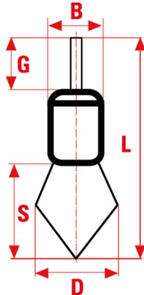
Pennelli in acciaio ondulato ad alta resistenza ed altissima densità di filo. La punta li rende adatti a lavori di precisione.
