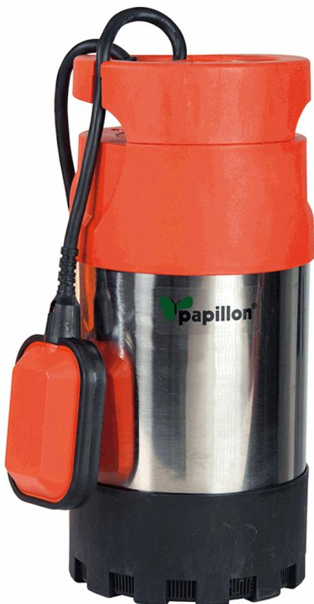
Elettropompa sommersibile 3 giranti PAPILLON mod. INOX BREAM - adatta per pompare acque chiare da pozzi, cisterne, serbatoi e stagni - indicata per altre applicazioni che richiedono alta pressione - corpo pompa in acciaio inox - potenza 800W - prevalenza max. 30 m - profondità di immersione 12 m - portata max: 5.500 L/h - dimensione granulometrica delle particelle: 1 mm - peso 8,50 kg - diametro tubazione in pressione/raccordo tubazione 1"
