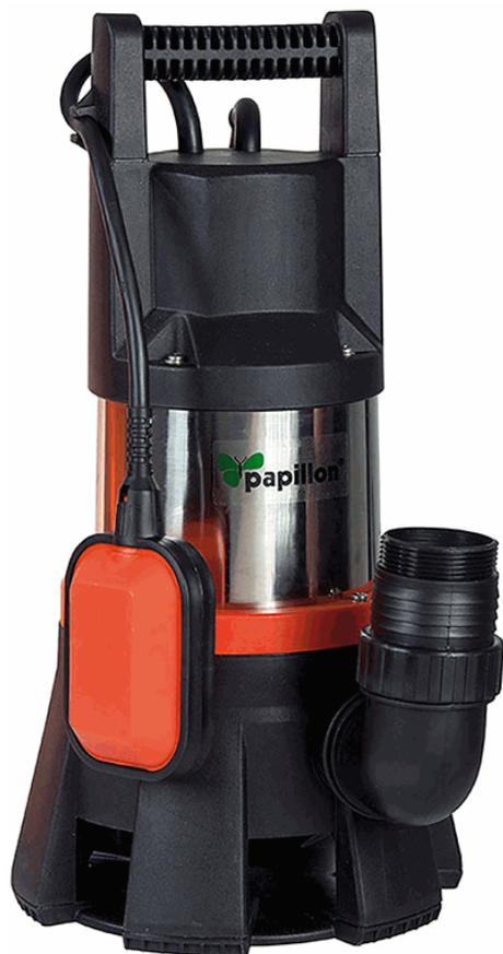
Elettropompa sommersibile PAPILLON mod. INOX ANGLER - per svuotamento, drenaggio di cantine, pozzi e piscine - adatta per pompare acque sporche contenenti particelle solide di diametro fino a 40 mm - 1300W - corpo pompa in acciaio inox - prevalenza max 11,5 m - profondità di immersione 7 m - portata max 25.000 L/h - peso 7,50 kg - diametro tubazione in pressione/raccordo tubazione 1.3/4", 2", 2.1/4"
