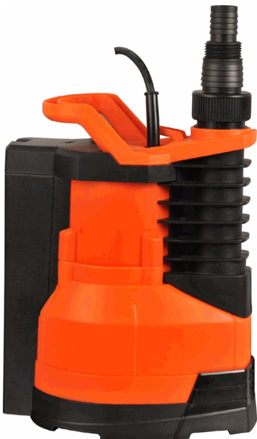
Elettropompa sommersibile PAPILLON mod. LOBSTER - con galleggiante integrato - ideale per l'impiego in pozzetti di dimensioni ridotte (minimo 30 x 24 cm) - adatta per pompare acque chiare contenenti particelle solide di diametro max. 5 mm - potenza 750W - prevalenza max. 8,5 m - profondità di immersione 7 m - portata max 13.000 L/h - peso 3,40 kg - diametro tubazione in pressione/raccordo tubazione 1", 1.1/2"
