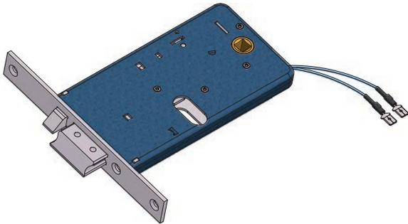
**CARATTERISTICHE COSTRUTTIVE:** Scatola e coperchio in acciaio zincato e plastificato - Frontale in acciaio nichelato e cromato - Scrocco in ottone cromato - Pistone di ricarica in acciaio nichelato - Ingegno maniglia in ottone foro  $\varnothing$  8 mm - Gruppo bobine cod. 035 (12V-15W a.c.) CE.
