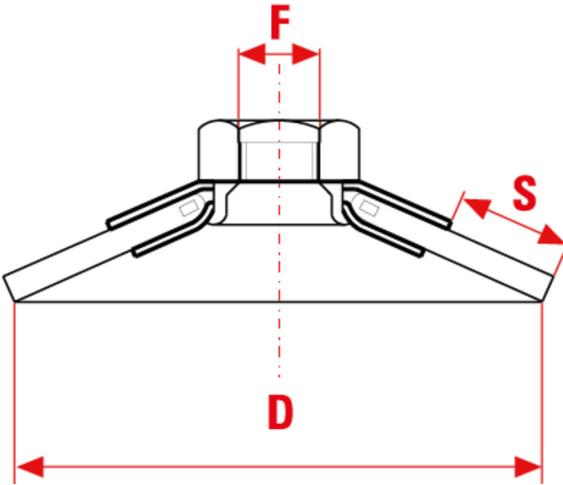
La forma conica rende queste spazzole adatte a lavori di taglio su superfici irregolari, con spigoli, profili e fessure. In acciaio ondulato ad altissima resistenza.
